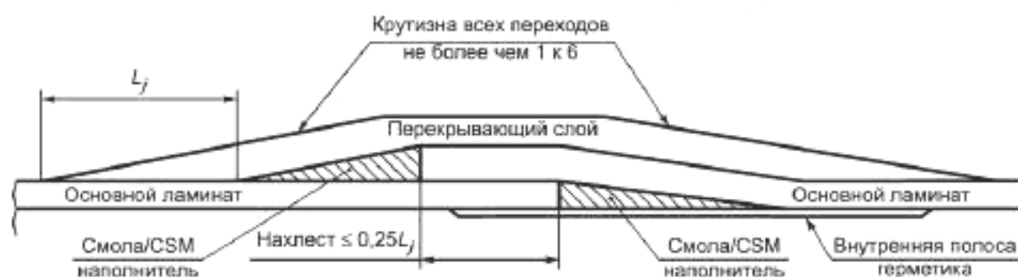
Рисунок И.2 — Основные типы сварных соединений для напорных емкостей без термопластичной футеровки: замковое стыковое соединение с ограничением по ширине основного ламината в 6 мм или меньше
