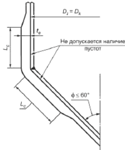
Рисунок Ж.5 — Коническое днище без изгиба
