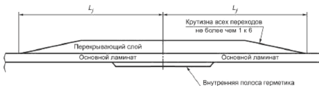
Рисунок И.1 — Основные типы сварных соединений для напорных емкостей без термопластичной футеровки: соединение встык с одиночным слоем перекрывающего ламината и с ограничением по ширине основного ламината в 6 мм или меньше
