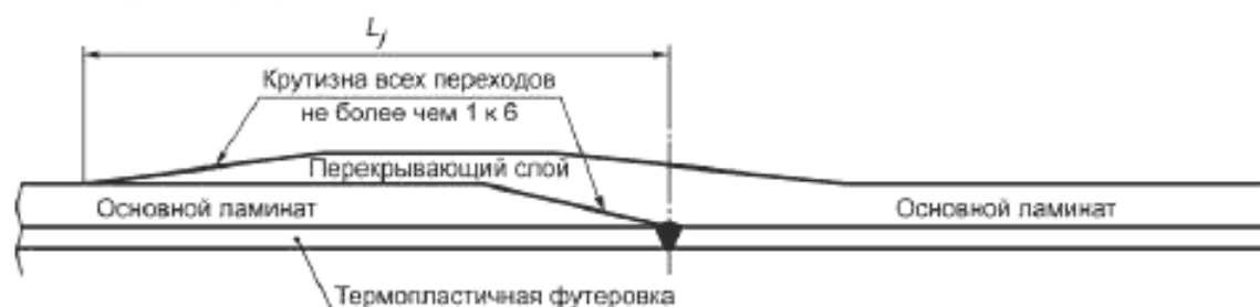
Рисунок И.8 — Основные типы сварных соединений для напорных емкостей с термопластичной футеровкой: соединение основного ламината внахлест
