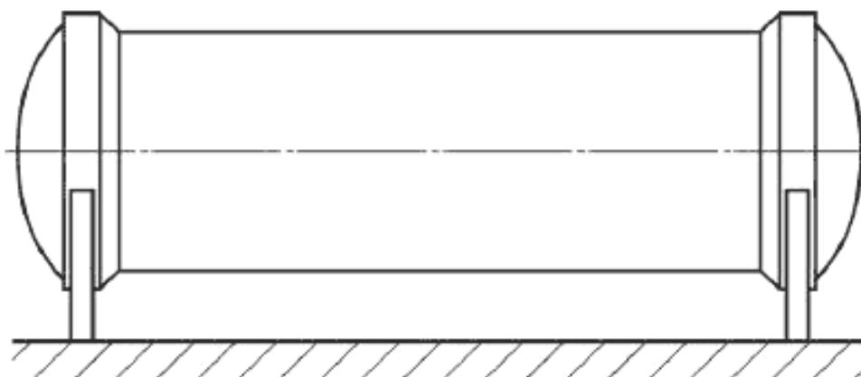
Рисунок 9.4 — Хранение емкости на двух опорах
