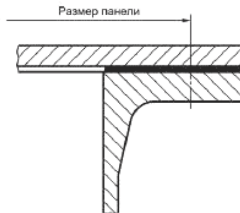
Рисунок Е.1 — Крепления в соответствии с типом 1: фланцевая заглушка с плоской опорной поверхностью
